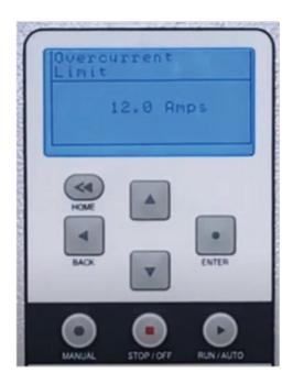
Selecciona el amperaje incluyendo el factor de servicio del motor a utilizar.
